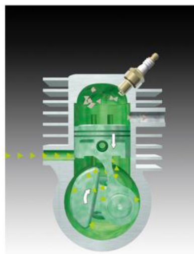
Práce, předkomprese a výfuk
